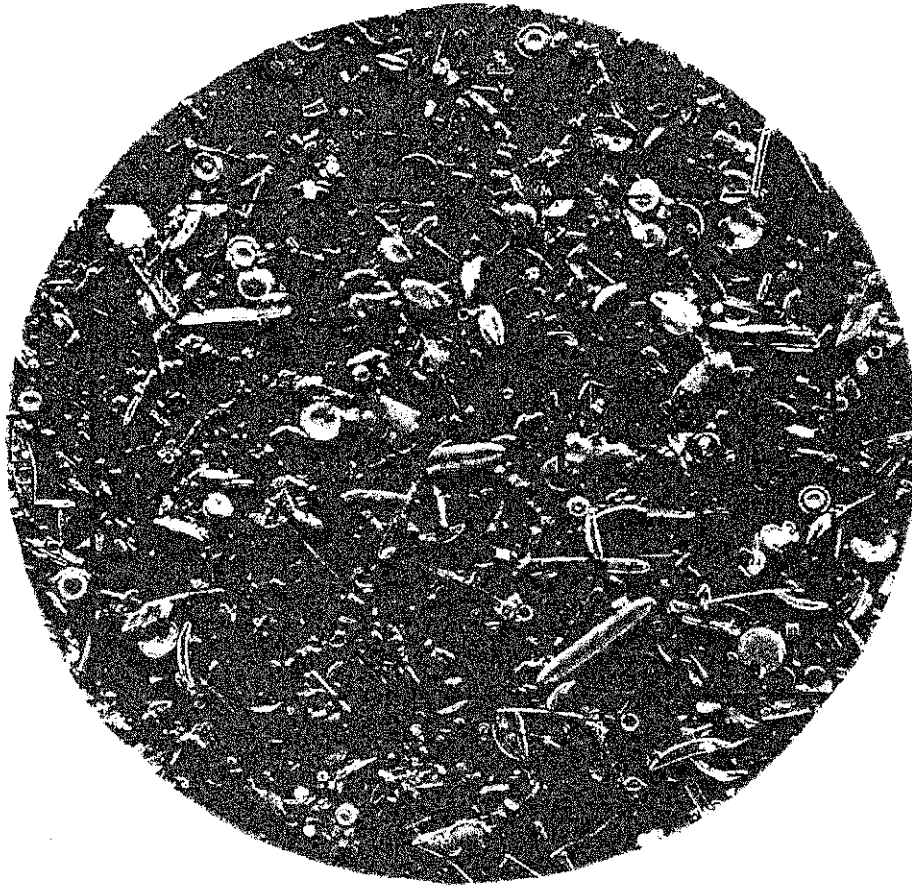
Bild 7. Schrägbedampftes Diatomeenpräparat, ideal für die Prüfung des Auflösungsvermögens von Objektiven geringer Vergrößerung. Objektiv 10 \times . Wenn die durch die unterbrochenen Linien angezeigte Fläche auf 20,3 \times 25,4 cm vergrößert wird, beträgt die Vergrößerung ungefähr 200 \times . Diese Mikrofotografie liegt den Abbildungen in Bild 8 zugrunde, um zu zeigen, daß die Auflösung selbst am äußersten Rand des Bildfeldes noch hinreichende Information liefert.
